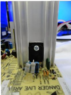
IC906 com Dissipador.
