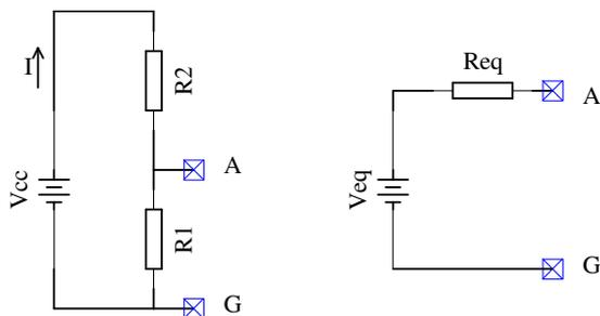
**Figura II.6** – Esquerda. Circuito de uma fonte de tensão de referência e seu equivalente Thévenin à direita.
