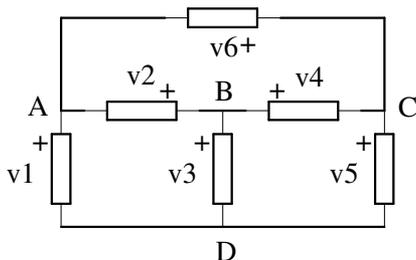
**Figura II.3** – Exemplo de circuito com as referências positivas estimadas das tensões.
