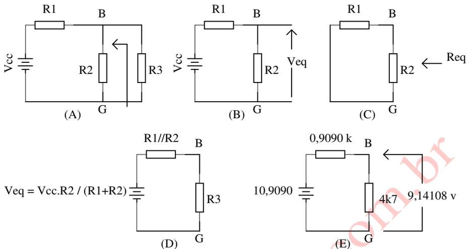
**Figura II.5** – Diversas etapas da aplicação do teorema de Thévenin até a solução do valor da tensão e impedância de saída.
