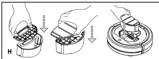
**B.** Cuidadosamente remova o Reservatório com filtro permanente e verifique se o Bocal de sucção está obstruído por alguma sujeira e limpe-o;
